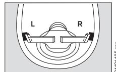
Ventilscheibe und -sitz müssen sauber und unbeschädigt sein, sonst reinigen oder austauschen. Ventilscheibe mit Wasser befeuchten und einsetzen. Bei waagerechtem Sitz muss die Ventilscheibe durch ihr Eigengewicht in die Führung hineingleiten. Federbrücke so einsetzen, dass beide Schenkel seitlich einrasten. Sie ist mit "L" = links und "R" = rechts gekennzeichnet und steht angewinkelt.
